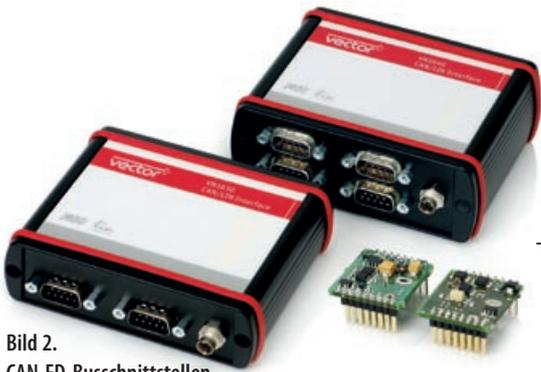
Bild 2. CAN-FD-Busschnittstellen mit Piggy-Back-Transceivern.
